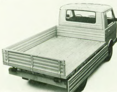
De laadvloer: 6 of 7,5 m 2
