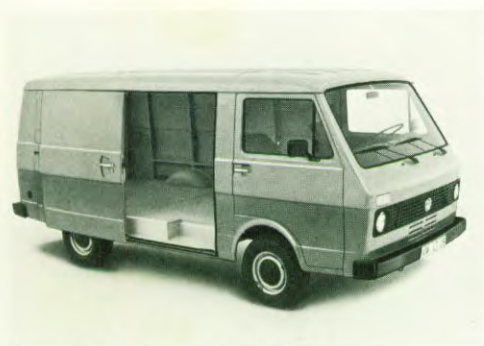
De schuifdeur kan niet dichtvallen
