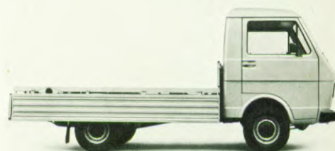
De zijschotten zijn geheel wegklapbaar
