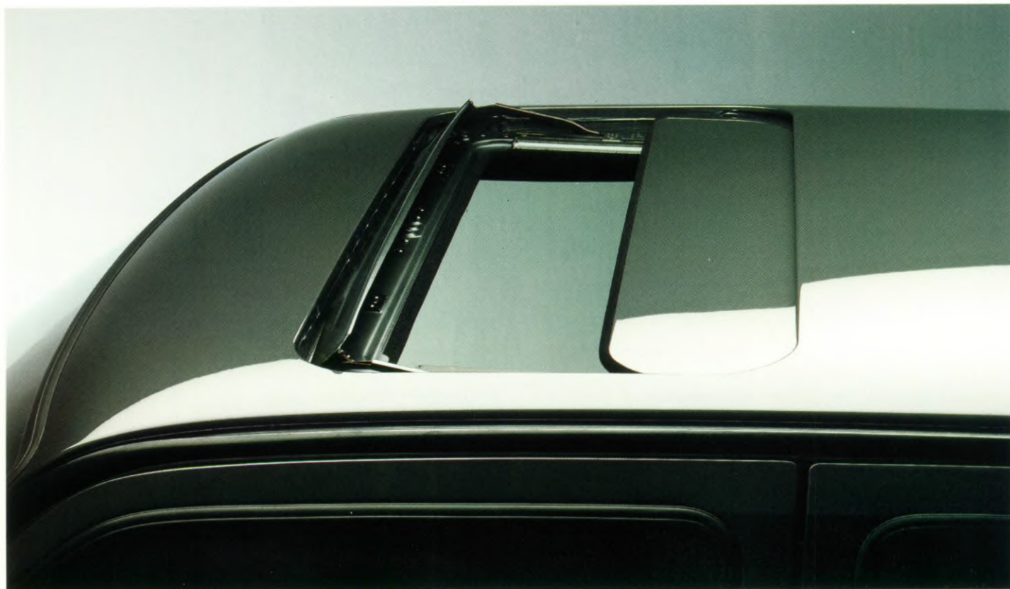
Schuifdak. Dit schuifdak heeft een zelfopklappend windscherm.
