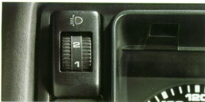
Verstelbare koplampen. Electrisch, exact in hoogte verstelbare koplampen al naar gelang de belasting van uw auto. Uw tegenliggers kunnen zo nooit meer verblind worden.
