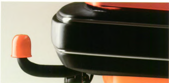
Trekhaak. Geschikt voor een groot aanhanggewicht. Het koelvermogen van de motor is hiervoor aangepast. (niet voor Nederland)
