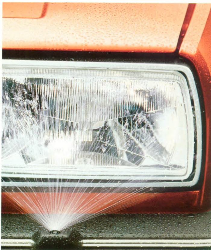
Koplampreinigings-installatie. Zo blijven uw koplampen altijd schoon, waardoor u de veiligheid hebt van een maximale lichtopbrengst.
