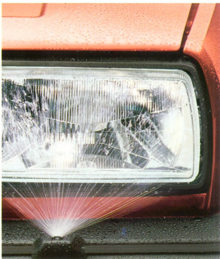
Koplichtreinigingsinstallatie. Zo blijven uw koplichten altijd schoon, waardoor u de veiligheid hebt van een maximale lichtopbrengst.
