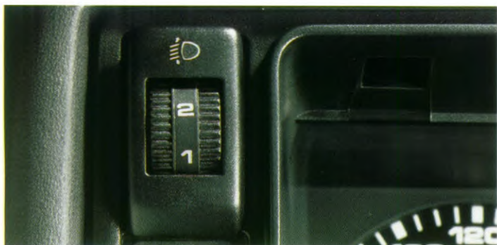
Verstelbare koplichten. Electrisch, exact in hoogte verstelbare koplichten al naar gelang de belasting van uw auto. Uw tegenliggers kunnen zo nooit meer verblind worden.
