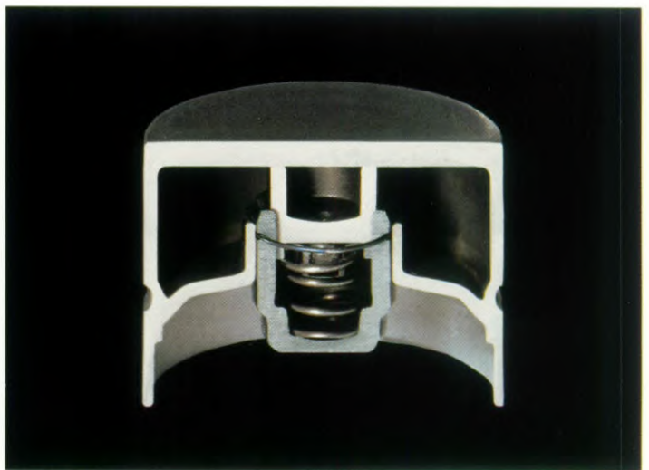
De hydraulische klepstoters. Deze klepstoters zijn onderhoudsvrij; er hoeven dus nooit kleppen gesteld te worden. Zij zorgen bij iedere nokkenasomwenteling voor de juiste klepspeling, met alle voordelen van dien.
