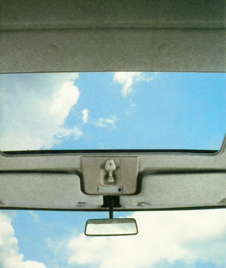
Schuifdak met automatisch opspringende windvanger.
