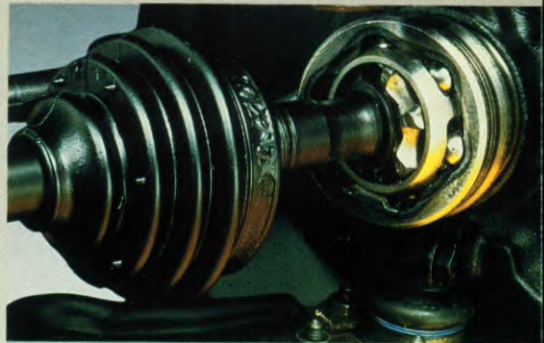
De homokinetische koppeling.
