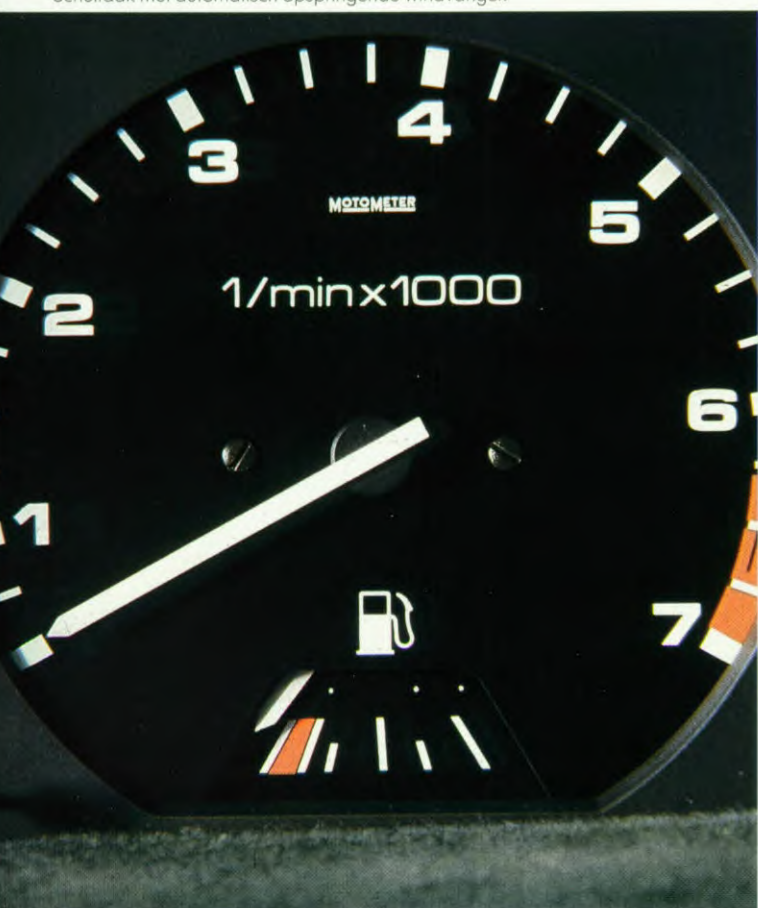
De toerenteller (standaard bij 66 kW en 82 kW motor)
