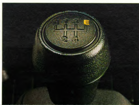
De 4+E versnellingsbak (standaard bij de turbo-diesel en 66 kW motor)
