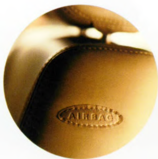
Für zusätzlichen Schutz beim Seitenaufprall: die Seitenairbags für Fahrer und Beifahrer.
