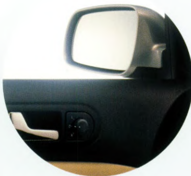
Vorbildlich: Die beheizbaren Außenspiegel lassen sich sogar elektrisch synchron einstellen.
