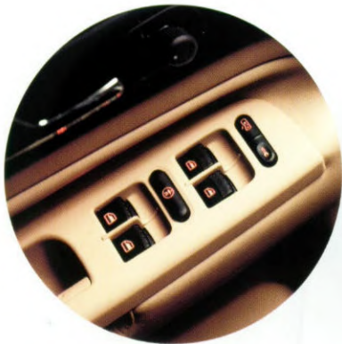
Angenehm: Tasten für Fensterheber und Zentralverriegelung in der Armlehne.
