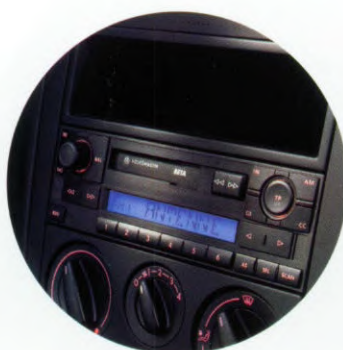
Radioanlage „beta“: 2 x 20 Watt, Radio-Daten-System RDS, vier Lautsprecher vorn. Auf Wunsch mit abnehmbarem Bedienteil.
