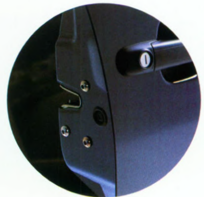
Langlebig: Die Schlösser liegen im Inneren der Tür und sind so vor Staub und Schmutz geschützt.
