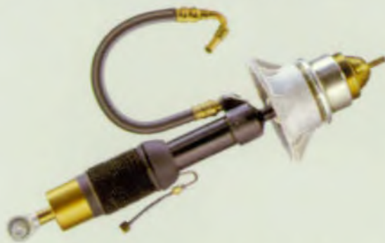
De niveauregeling zorgt voor een konstant wagenniveau.
