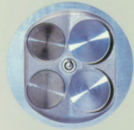
Ten opzichte van de tweekleppen-tech- niek biedt de vierkleppen-techniek meer vermogen en een hoger koppel.
