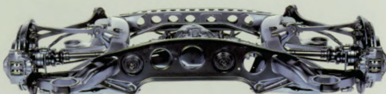
De ruimtelijk geleide achteras beperkt eigen stuurbewegingen en houdt de S-klasse Coupé exakt op de juiste koers
