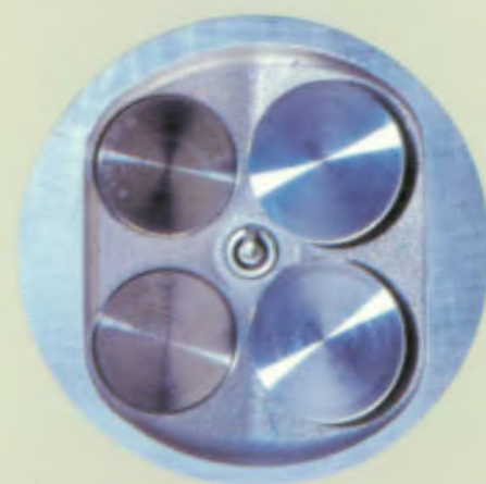
Vergeleken met de tweekleppen-techniek biedt de vierkleppen-techniek duidelijk grotere totale klepopeningen.
