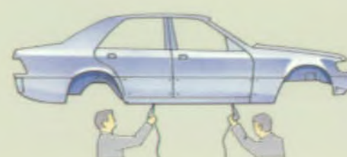
PVC-afdichting van de naden
