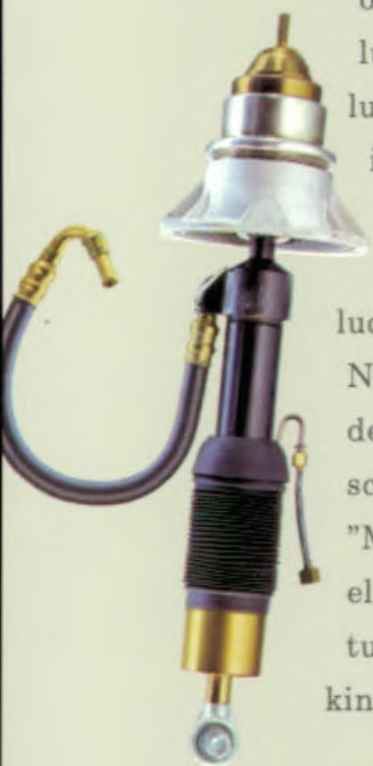
De niveauregeling zorgt voor een constant wagenniveau.
