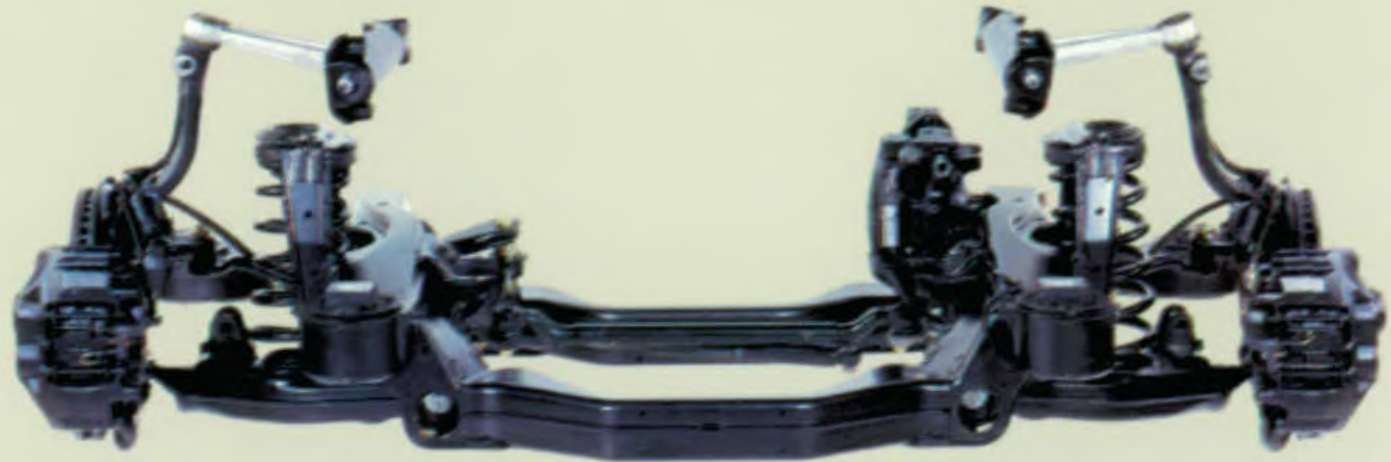
De vooras met dubbele wieldraagarmen zorgt voor een beter rijgedrag.
