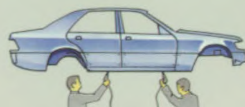
PVC-afdichting van de naden
