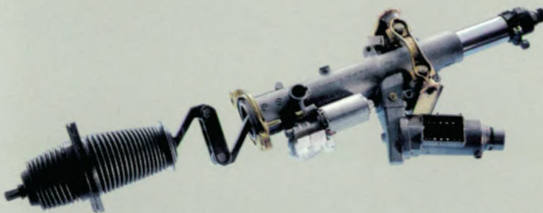
De elektrisch verstelbare stuurkolom. Met één druk op de knop de ideale stand.
