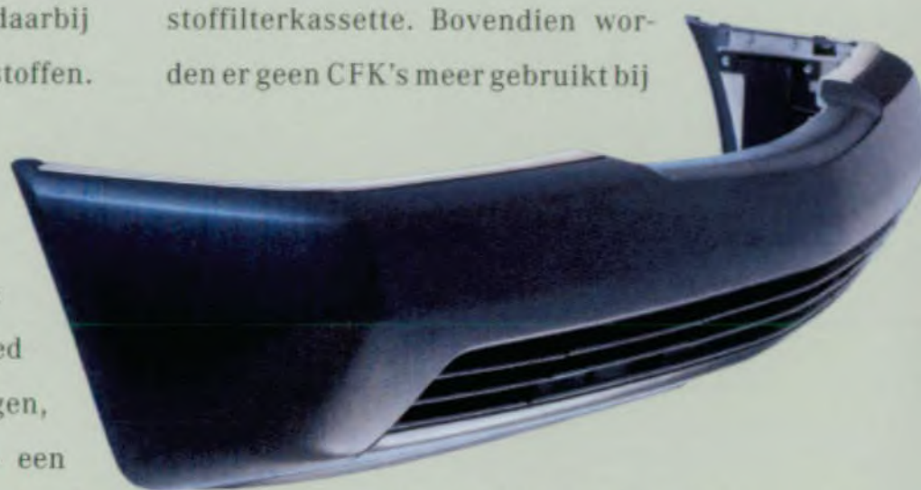
Bij de S-klasse zijn alle kunststofdelen van meer dan 100 gram in de S-klasse gekodeerd, teneinde een gesorteerde recycling mogelijk te maken.
