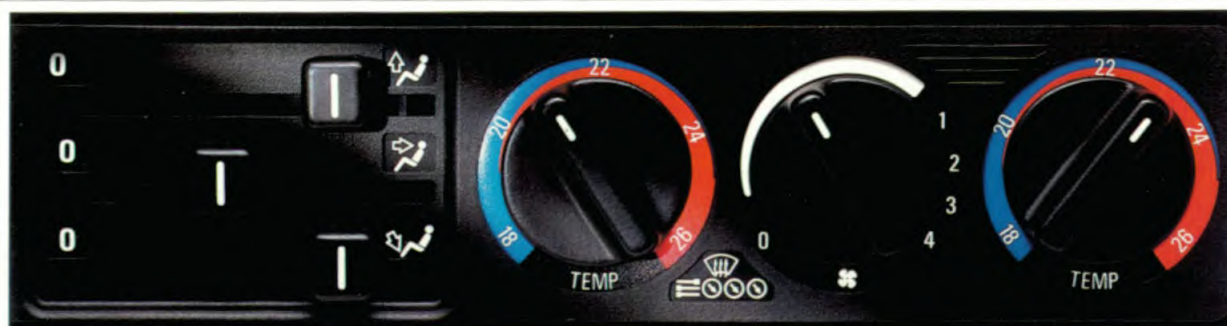
Elektronisch geregelde verwarming en ventilatie. Voor bestuurder en passagier gescheiden regelbaar. Perfecte luchtverdeling. Stille, krachtige aanjager voor een snelle luchtdoorvoer.
