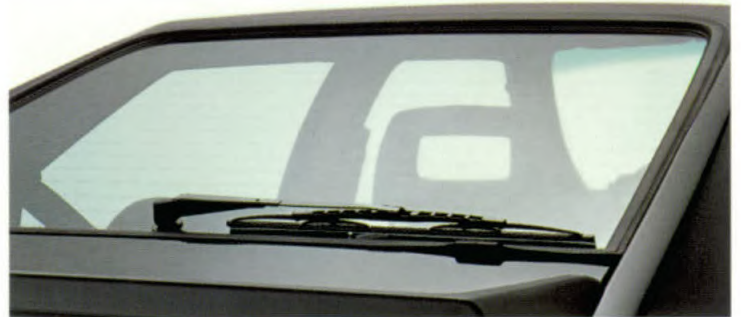
Achterraut met wis-was-installatie.
