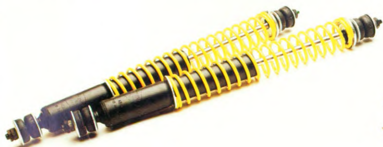
SCHOKDEMPERS met extra veren, die de gewone vering aanvullen tijdens het rijden met een aanhangwagen of caravan.
