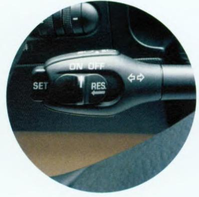
Per Knopfdruck hält die Geschwindigkeitsregelanlage ein konstantes Tempo (ab 66 kW (90 PS)-Motoren).
