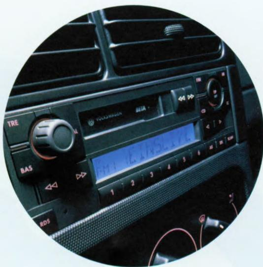
Die Radioanlage „beta“. Mit  $2 \times 20$  Watt und vier Lautsprechern in der Armaturentafel (Serie bei Comfortline).
