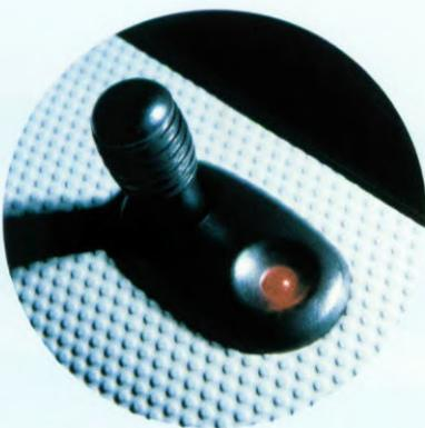
**Die Blinkleuchte zeigt deutlich: Die Diebstahlalarmanlage ist aktiviert.**
