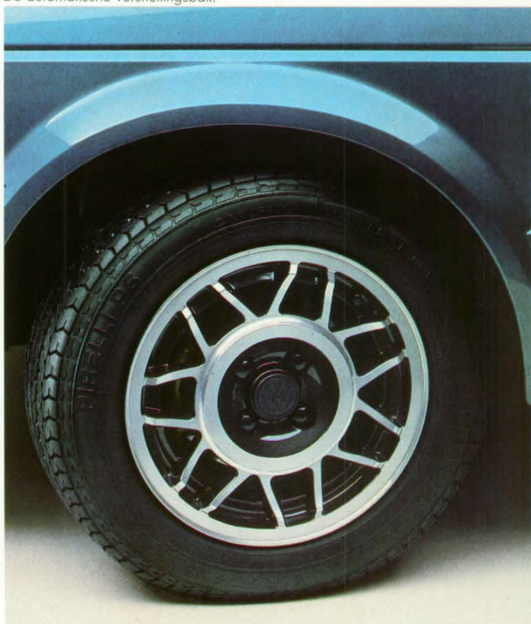
De 6 J x 14 lichtmetalen velg met 185/60 HR 14 banden.
