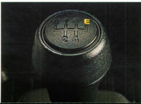
De 4+E versnellingsbak. Standaard bij 51 kW Turbo-Diesel en 66 kW benzinemotor.
