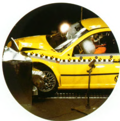
Bij een halffrontale botsing tegen een vervormbaar object blijft de veiligheidskooi vrijwel volledig intact.
