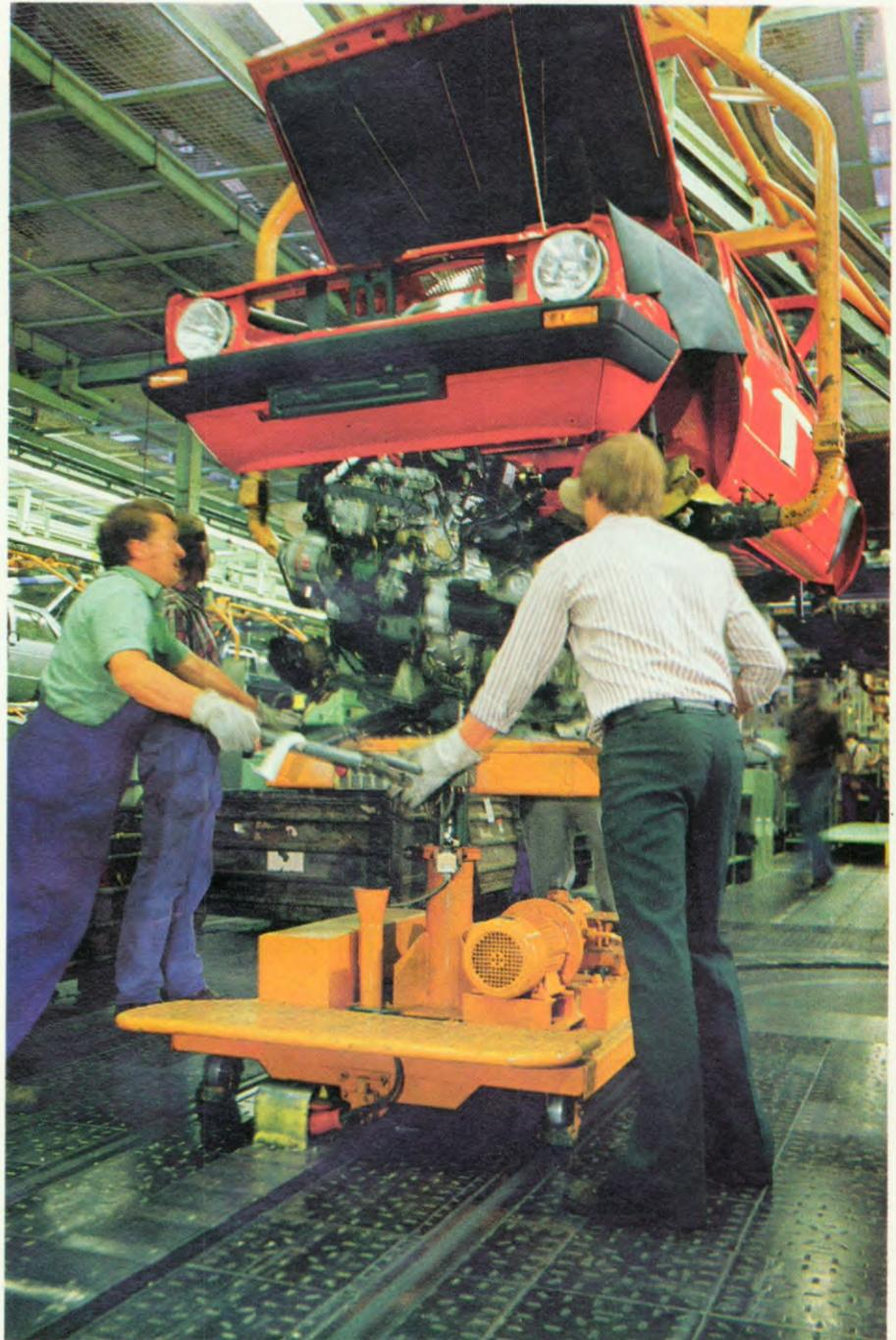
Kabel, Züge, Handbremsseil und Bremschläuche anschließen, Kühl- und Bremssystem befüllen, Räder montieren, Öl und Benzin auftanken, Sitze einbauen – der Golf ist fertig und fährt zum ersten Mal mit eigener Kraft. Auf dem Achsmeßstand werden Spur und Radsturz eingestellt, damit die „Straßenlage“ hundertprozentig stimmt. Nach dieser Prozedur wird das Lenkrad ausgerichtet und festgeschraubt.
