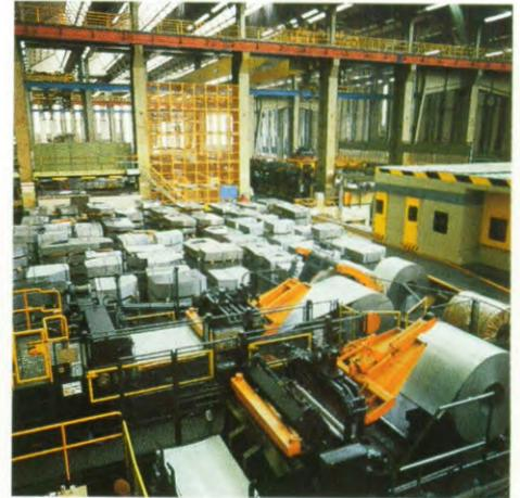
Großpressen pro Tag bis zu 2.000 Tonnen Stahlblech. Mit Kräften bis zu 3.800 Tonnen entstehen in den – vielfach gegen Lärm gekapselten – Großteil-Pressen die Blechteile für Dächer, Seitenteile, Türen, Klappen und Bodengruppen. Bis zu 18 Teile in der Minute. Selbsttätige Greifer packen mühelos zu, transportieren die Blechteile von Presse zu Presse. Die Mitarbeiter steuern und überwachen den Prozeß, alles andere geschieht vollautomatisch.
