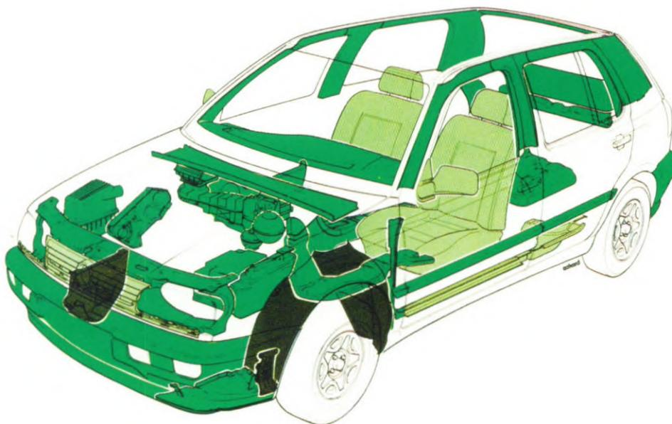
Schon heute lassen sich fast alle Kunststoffteile des Golf wiederverwerten. Ein Beispiel sind Kunststoffstoßfänger, die nach sortenreiner Trennung und stofflicher Aufbereitung zur erneuten Herstellung von Stoßfängern als Rohmaterial verwendet werden.
