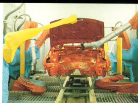
Automatisch wird nun der Unterbodenschutz gespritzt. Mit speziellen Kunststoffen werden die Nähte abgedichtet. Die nun folgende Technik des Lackierens kennt keine herkömmlichen Spritzpistolen mehr. Bei Füller, Deck- und Klarlack dominieren hochmoderne automatische Lackierverfahren. Dabei übernehmen Roboter die Innenraumlackierung, Hochrotationsglocken-Automaten – sie rotieren mit bis zu 35.000 Umdrehungen pro Minute – erledigen die Außenbeschichtung.
