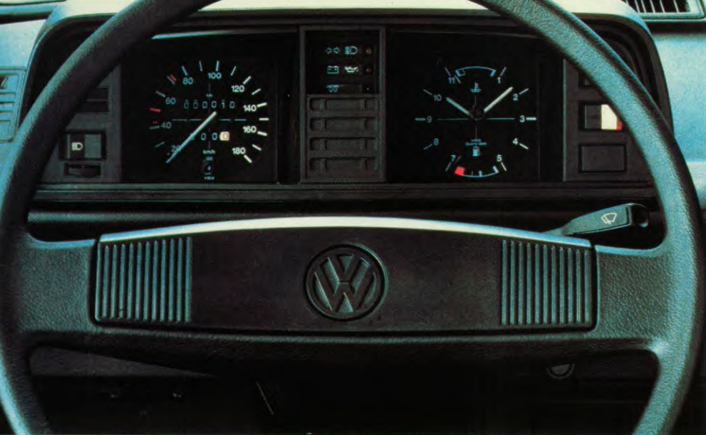
Het dashboard van de Caravelle CL. Standaard voorzien van een dagteller, een klok
