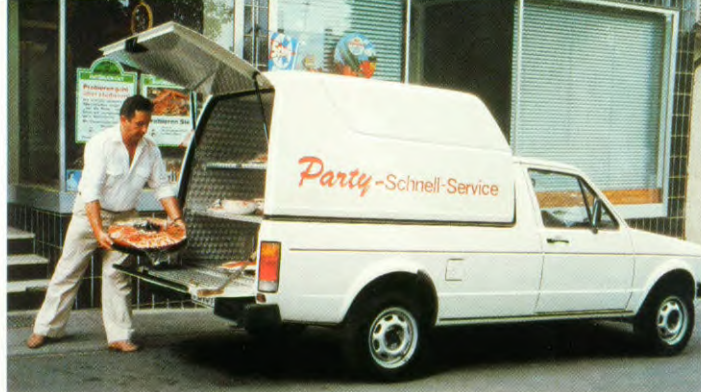
Standaardopbouw, ingericht voor het vervoer van bederfelijke waar
