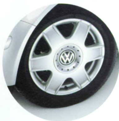
Dynamisch: die Leichtmetallräder „Le Castellet“ 6½ J × 16 mit 205/55 R 16 Bereifung und Rad-sicherungen.
