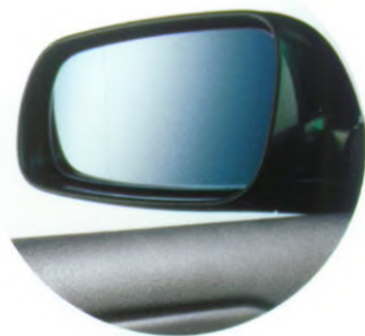
Freie Rücksicht: elektrisch synchron einstell- und beheizbare Außenspiegel mit blaugetöntem Glas.
