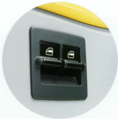
Mit Komfortschließung und Einklemmschutz: die elektrischen Fensterheber vorn.
