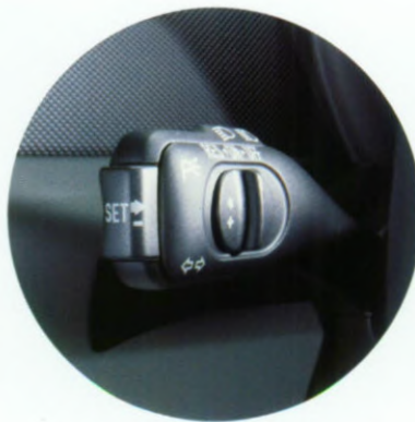
Komfortabel: Die Geschwindigkeitsregelanlage hält automatisch das Tempo konstant.
