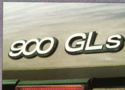
Het GLs model. Aangedreven door een motor met twee carburateurs die 79 kW (108 PK) ontwikkelt, met handgeschakelde 5-versnellingsbak of automatische transmissie.
