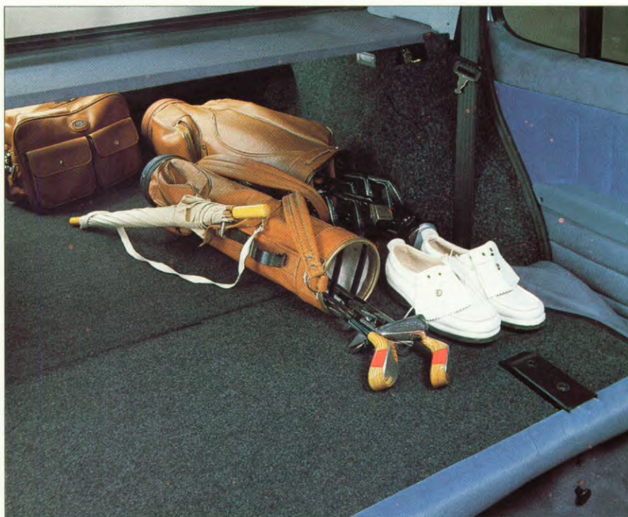
De inhoud van de bagageruimte kan meer dan verdubbeld worden door de zitting en de leuning van de achterbank neer te klappen. De Combi Coupé heeft dan een laadcapaciteit van 1,6 m 3 en de Sedan van 1,5 m 3 .
