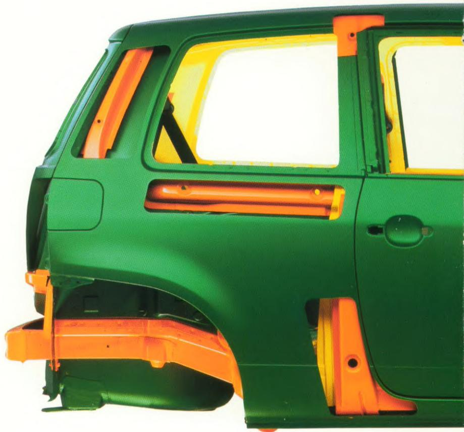
der A-, B- und C-Säule, die die Widerstandsfähigkeit von Türen und Dach erhöhen. Für einen stärkeren Seitenaufprallschutz wurden besonders breite Verstärkungsprofile in den Türen mit großflächigen Polyurethan-Hartschaum-Formstücken kombiniert. Eine völlig neu konstruierte Verankerung im unteren Türprofil ergänzt den Schutz bei einer Seitenkollision.
