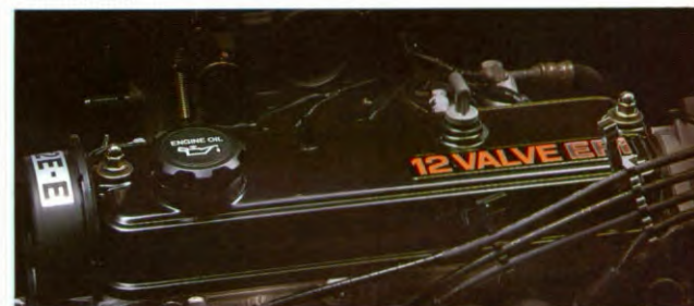
1.3 LITER INJECTIEMOTOR 55 kW/6000 omw 1 101 Nm/4800 omw 1
