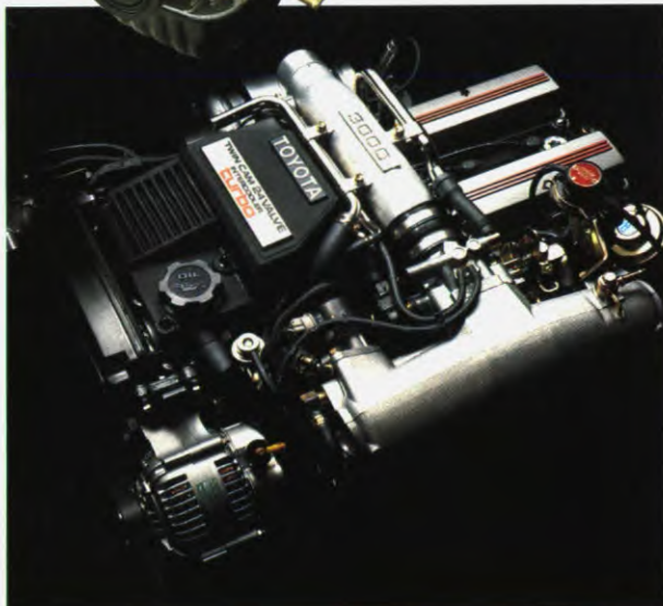
6-Cilinder motor met 24 kleppen en Turbo Intercooler van de Toyota Supra
