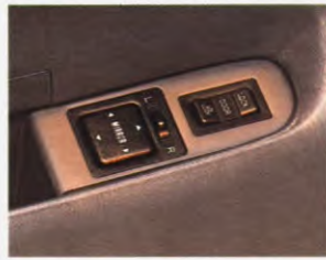
CENTRALE PORTIER- VERGREDELING EN ELEKTRISCH BEDIEN- BARE SPIEGELS. U kunt de centrale portiervergrendeling (XL + GL-model) en de elektrisch bedienbare spiegels (GL) met uw vingertoppen commanderen.
