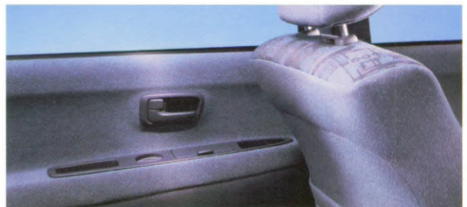
Op de belangrijkste plaatsen in het interieur zijn schokabsorberende materialen aangebracht die bij een botsing voor minder lichamelijke belasting zorgen.
