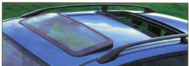
Voor de GLi en GXi is er als optie een dubbel zonnedak leverbaar; het voorste handbediend uitklapbaar, het achterste elektrisch schuifbaar.
