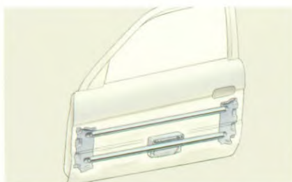
◆ De carrosseriestructuur is zo ontworpen, dat de energie die bij een botsing vrijkomt direct optimaal wordt verwerkt, bijvoorbeeld langs de beschermingsbalken in de portieren naar de rest van de carrosserie.
