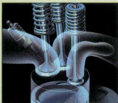
DRIE KLEPPEN PER CYLINDER — TWEE INLAATKLEPPEN EN ÉÉN UITLAATKLEP — ZORGEN VOOR EEN PERFEKTE "ADEMHALING", EEN IDEEAAL MENGSEL EN DAARDOOR OPTIMALE VERBRANDING.
