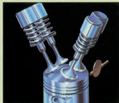
EEN 16 KLEPPEN-MOTOR TELT 4 KLEPPEN PER CYLINDER — TWEE INLAATKLEPPEN EN TWEE UITLAATKLEPPEN — DIE WERKELIJK TOPPRESTATIES LEVEREN.
