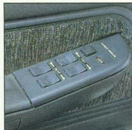
Glaces électriques AV/AR avec commande centralisée côté conducteur de série (R, RS)
