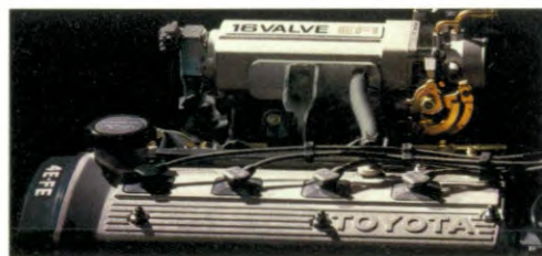
■ 16V 1300i. 65 kW (89 pk)/6.000 omw. min, 111 Nm/4.800-5.200 omw. min.
