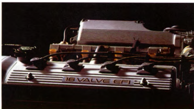
■ 16V 1600i. 84 kW (114 pk)/6.000 omw. min, 145 Nm/4.800-5.200 omw. min.
