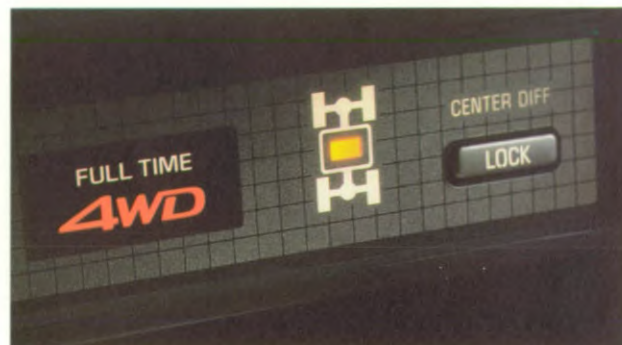
MIDDENDIFFERENTIEEL MET SLOT Schakelt u in wanneer u met de Corolla 4WD in modder of sneeuw terecht komt.
