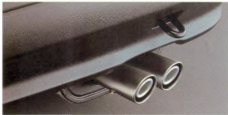
DUBBELE UITLAATPIJPEN. Om de GT-modellen een extra sportief aanzien en geluid te geven, zijn ze voorzien van een uitlaat met dubbele pijp.
