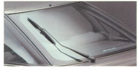
RUITENWISSER-INTERVALSYSTEEM. De achterrauit wordt veilig ontdaan van regen en sneeuw door 'n ruitenwisser-intervalsysteem.
