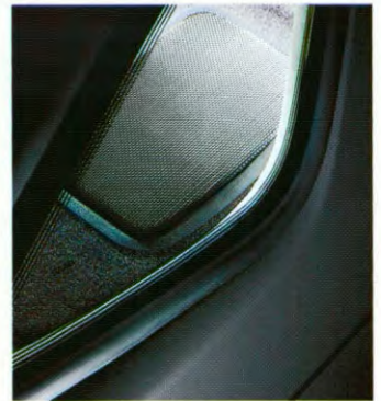
Luidsprekers voor montage in voorbereide ruimtes in het dashboard (40 W) en in de hoedenplank (50 W).
