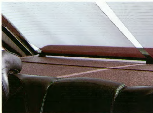
Rolgordijn voor de binnenzijde van de achterraut. Houdt het directe zonlicht tegen en vermindert de warmte die het interieur binnendringt. De structuur van het gebruikte materiaal stelt de bestuurder echter in staat via de binnenspiegel door de achterraut te kijken.
