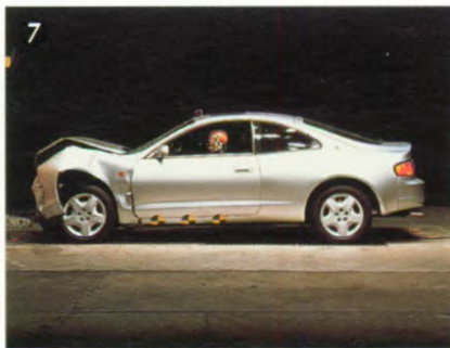
7-8. Met de Celica werden de meest uiteenlopende botsproeven uitgevoerd, waardoor onder meer de kreukelzones voor en achter zijn geperfectioneerd.
