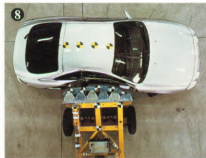
Uiteraard werden ook zijdelingse botsingen nagebootst. Dankzij de extra sterke portierstijlen, balken in de portieren en solide dorpels overtreft de Celica alle internationale veiligheidseisen.
