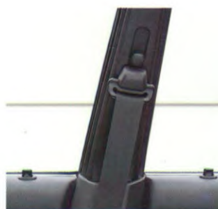
VARIABELE HOOGTE- INSTELLING AUTOGORDELS De geleiding van de autogordels vóór kan in vijf verschillende standen worden aangepast. Voor nog meer comfort.
