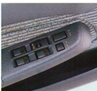
ELEKTRISCHE RUITBEDIENING Met dit bedieningspaneel, aan de kant van de bestuurder, kunt u met uw vingertoppen de ruiten openen en sluiten en de portieren centraal vergrendelen (GL).
