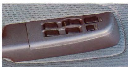
ELEKTRISCHE RUITBEDIENING Met dit bedieningspaneel, aan de kant van de bestuurder, kunt u met uw vingertoppen de ruiten openen en sluiten en de portieren centraal vergrendelen (GL).
