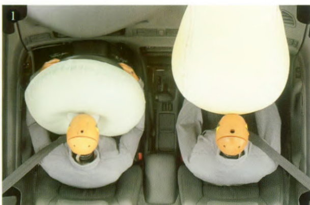
1. Bij een frontale botsing biedt de combinatie van fullsize airbags met veiligheidsgordels en gordelspanners de best mogelijke bescherming. Veiligheidsgordels dienen uiteraard altijd te worden gedragen.
