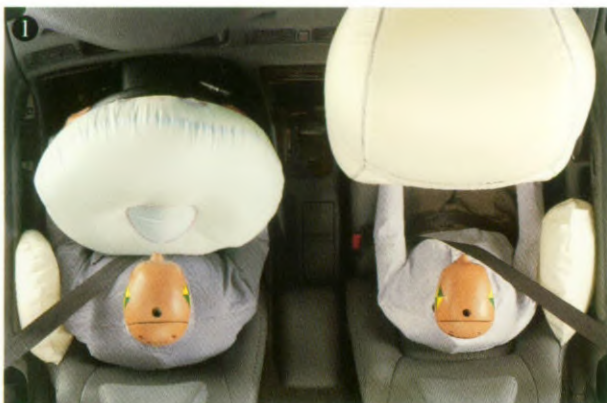
1. Bij een frontale botsing biedt de combinatie van fullsize airbags met veiligheidsgordels en gordelspanners de best mogelijke bescherming. Side-airbags beschermen bij een zijdelingse botsing.
