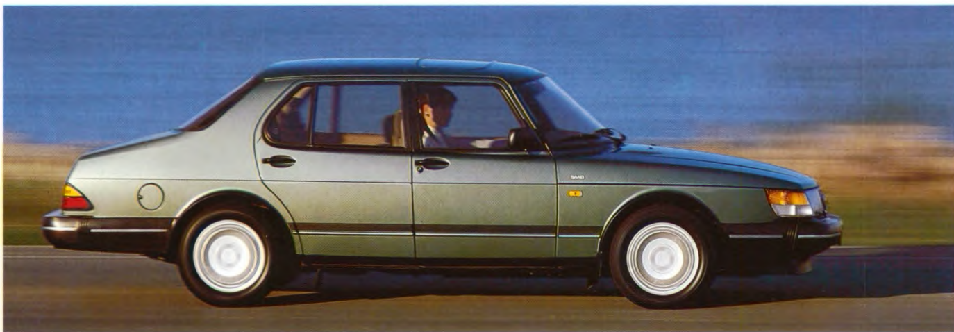
De lage, gestroomlijnde voorkant met de licht gebogen, ronde hoeken, de gewelfde voorruit en de betrekkelijk vlakke onderkant dragen eveneens bij tot de betrekkelijk lage luchtweerstand van de auto.
