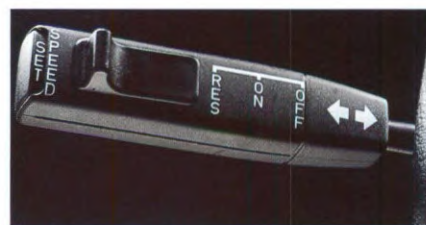
Met Cruise Control blijft de auto automatisch op de voorgeselecteerde snelheid verder rijden, ongeacht de helling van de weg, tegenwind, enz.
