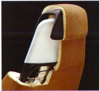
De hoofdsteun op de voorstoel bestaat uit schuimmateriaal dat rondom een veerkrachtige steunplaat is opgebouwd.
