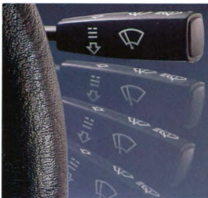
De ruitewissers kunnen op twee snelheden of met intervalwerking worden ingesteld. Wanneer de sproeiers worden aanzet, gaan de voorruit- en koplampwissers automatisch 3-5 keer heen en weer.
