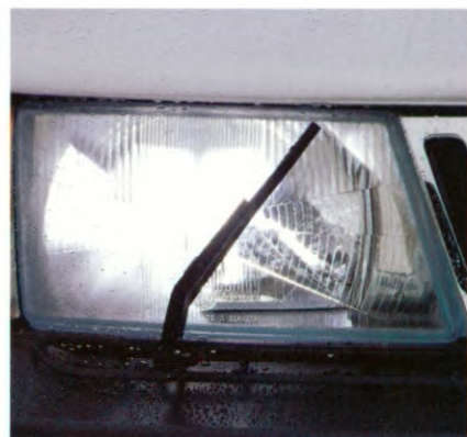
De koplampsproeiers- en wissers zijn een van de innovaties van Saab die gericht zijn op het verbeteren van de rijveiligheid. Wanneer de vooruitsproeiers worden aanzet, worden ook de koplampwissers in werking gesteld.
