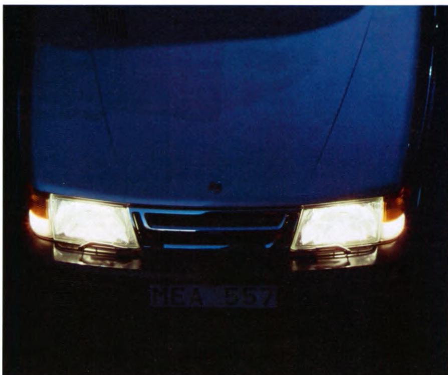
Halogeen koplampen behoren tot de standaarduitrusting. Deze lampen geven een langere, bredere en helderder lichtstraal dan conventionele lampen.
