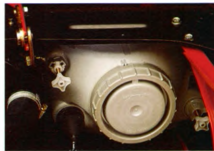
De koplampen kunnen gemakkelijk van binnenuit door middel van twee knoppen worden bijgesteld – er is geen gereedschap voor nodig.
