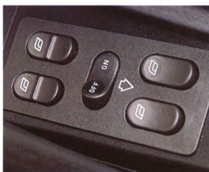
Elektrisch bediende ramen. De ramen van de achterportieren kunnen door middel van schakelaars in de portieren en op de middenconsole worden bediend.
