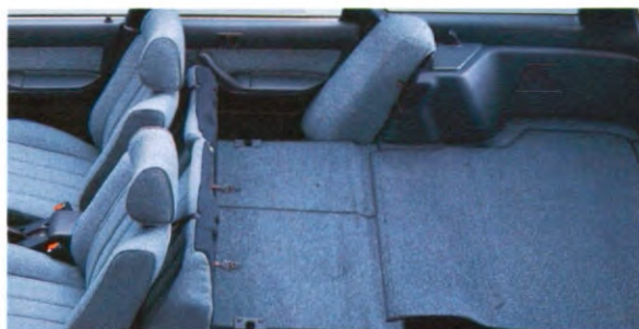
ACHTERBANK NEERGEKLAPT Met omgeklapte zitting en rugleuning wordt het bagageruim tweemaal zo groot. Door de 60/40 gedeelde achterbank kunt u ook lange voorwerpen vervoeren.
