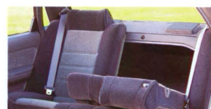
GESCEIDEN NEERKLAPBARE ACHTERBANKLEUNING Voor het vervoeren van "grote" voorwerpen, kunt u de leuning van de achterbank geheel of gedeeltelijk 60/40 naar voren klappen. De toch al omvangrijke kofferruimte wordt daarmee drastisch uitgebreid. (GLi/GXi.) (Veiligheidsgordels achter niet voor Nederland)
