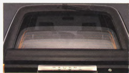
ELEKTRISCH BEDIENBARE ACHTERRUIT Kan zowel van binnen als van buiten worden bediend. Als het om kleine bagage gaat, hoeft u dus niet altijd de achterdeur te openen.
