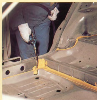
4 Mastiek. Mastiek tussen de felsenaden, zowel aan de binnen- als aan de buitenkant van de body.
