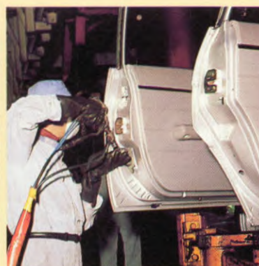
9 Wasbehandeling door drukinspuiting in holle delen. Beschermt binnenwanden en voorkomt dat water tussen de plaatverbindingen dringt.
