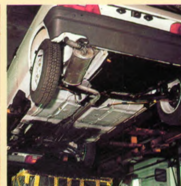
10 Undercoating op bitumenbasis. Voorkomt binnendringen van water en vocht in holle delen.
